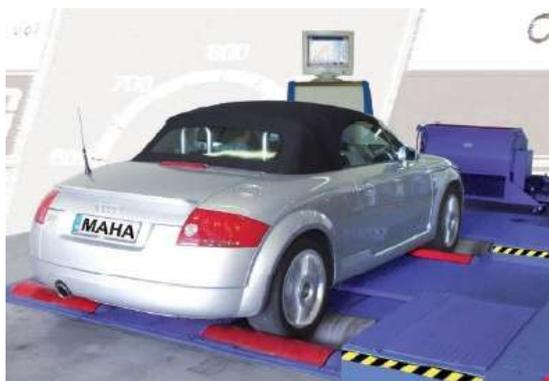
圖 6-1-5、底盤動力試驗設備
