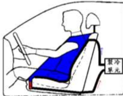
圖 6-1-1、空調椅系統整體構造
