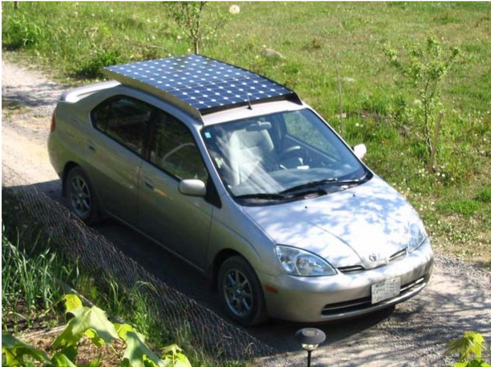
圖表 50 太陽能結合混合動力(油電)車
