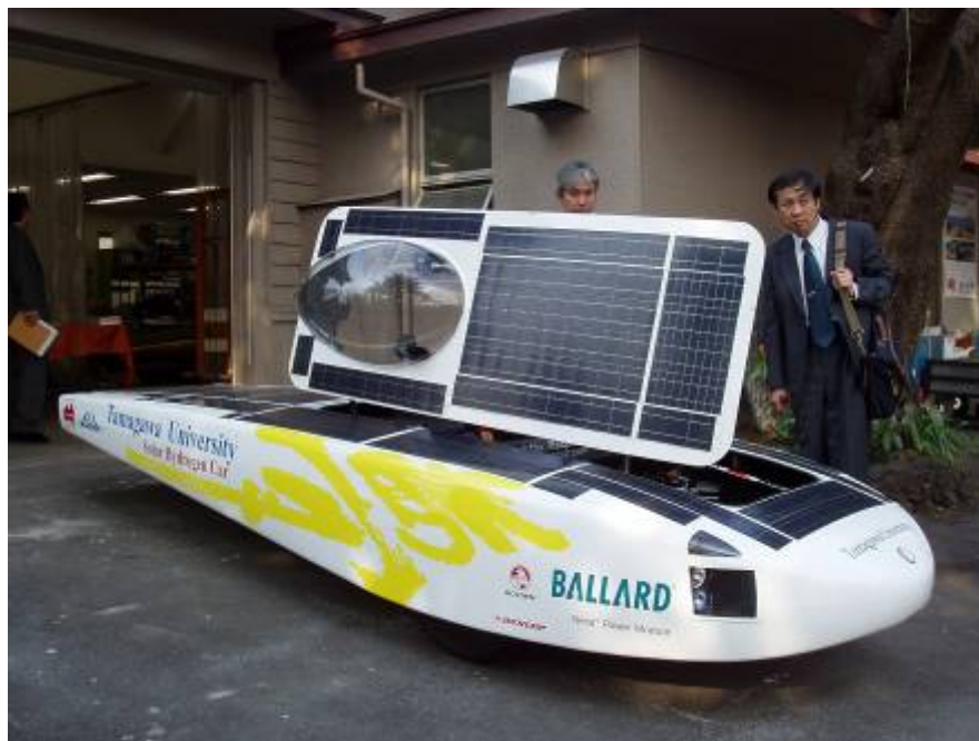
圖表 2 日本玉川大學之太陽能 - 燃料電池車
